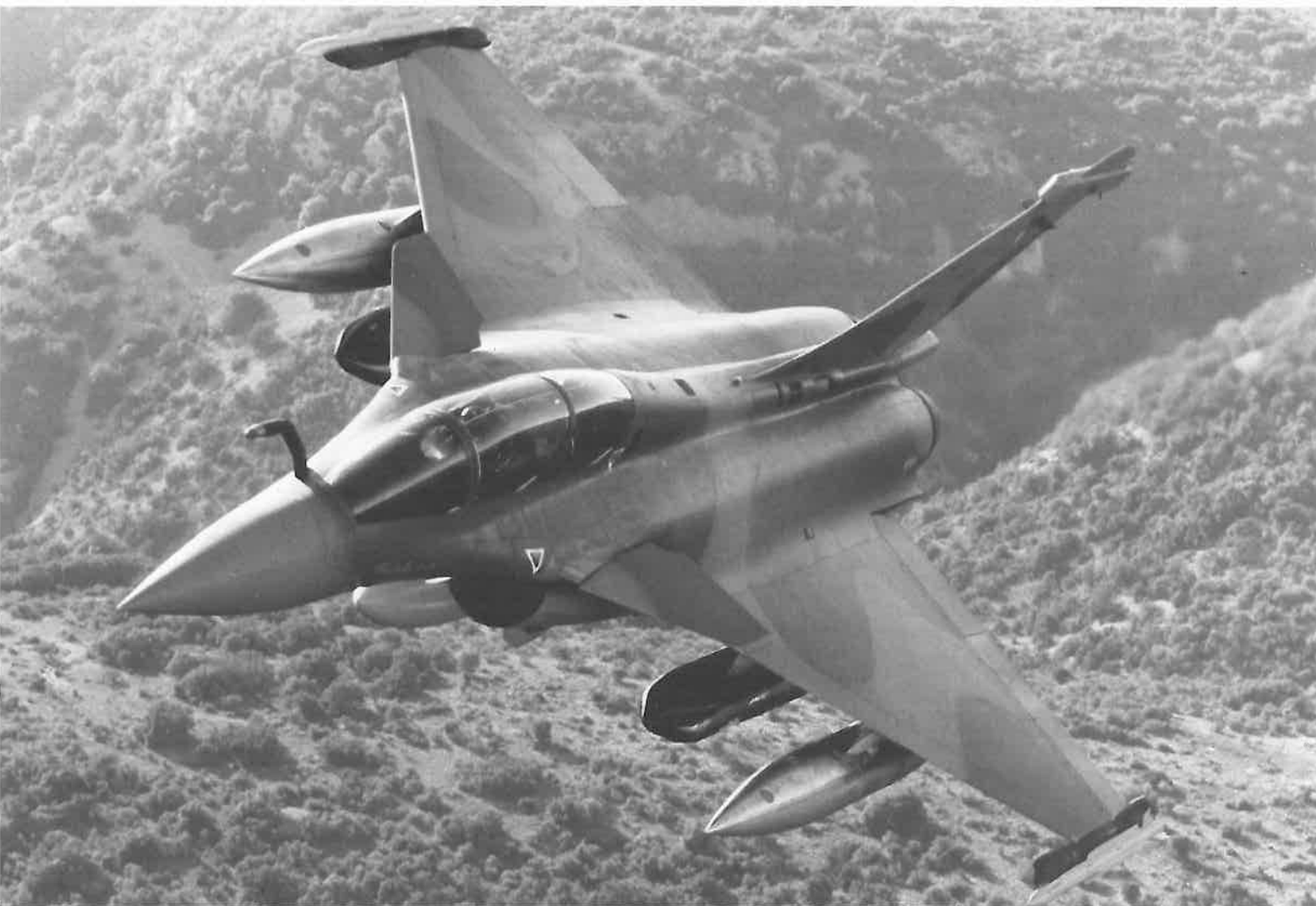
Rafale genomförde dagliga uppvisningar på Le Bourget. På bilden är flygplanet bestyckat med radarjaktrobot MICA i vingspetsarna och attackrobot Apache på de inre vingbalkarna. Foto: Dassault/Aviaplans Service
