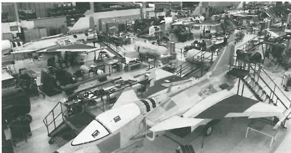
Vy över slutmonteringshallen för JAS 39 A vid Saab Military Aircraft där monteringen nu sker på två "liner"
