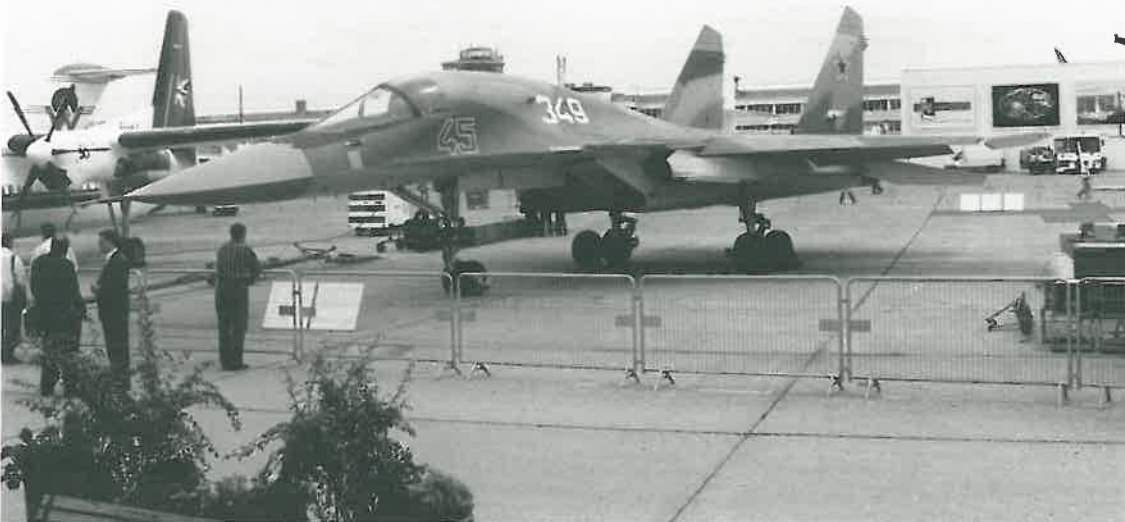
Attackflygplanet Su-34 på den statiska utställningen. Besättningen är placerad side-by-side och kommer in i cockpit via noshjulets landställsschakt. Den turkosa målningen sades vara speciellt framtagen för att kunna utnyttja flygplanet vid sjömålsföretag
