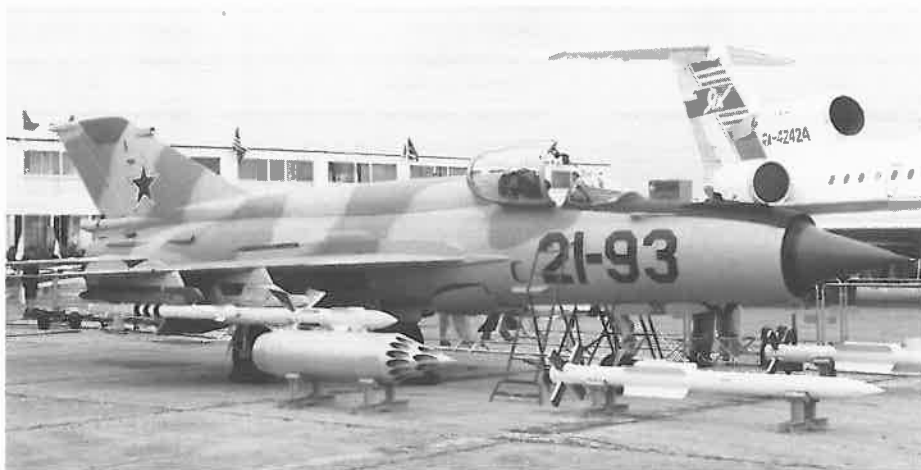
Mikoyans uppgraderingsprojekt MiG-21-93. Jaktbeväpningen utgörs av de senaste ryska jaktrobotarna R-27 (semiaktiv radarmålsökare), R-73 (IR-målsökare) samt R-77 (aktiv radarmålsökare)
